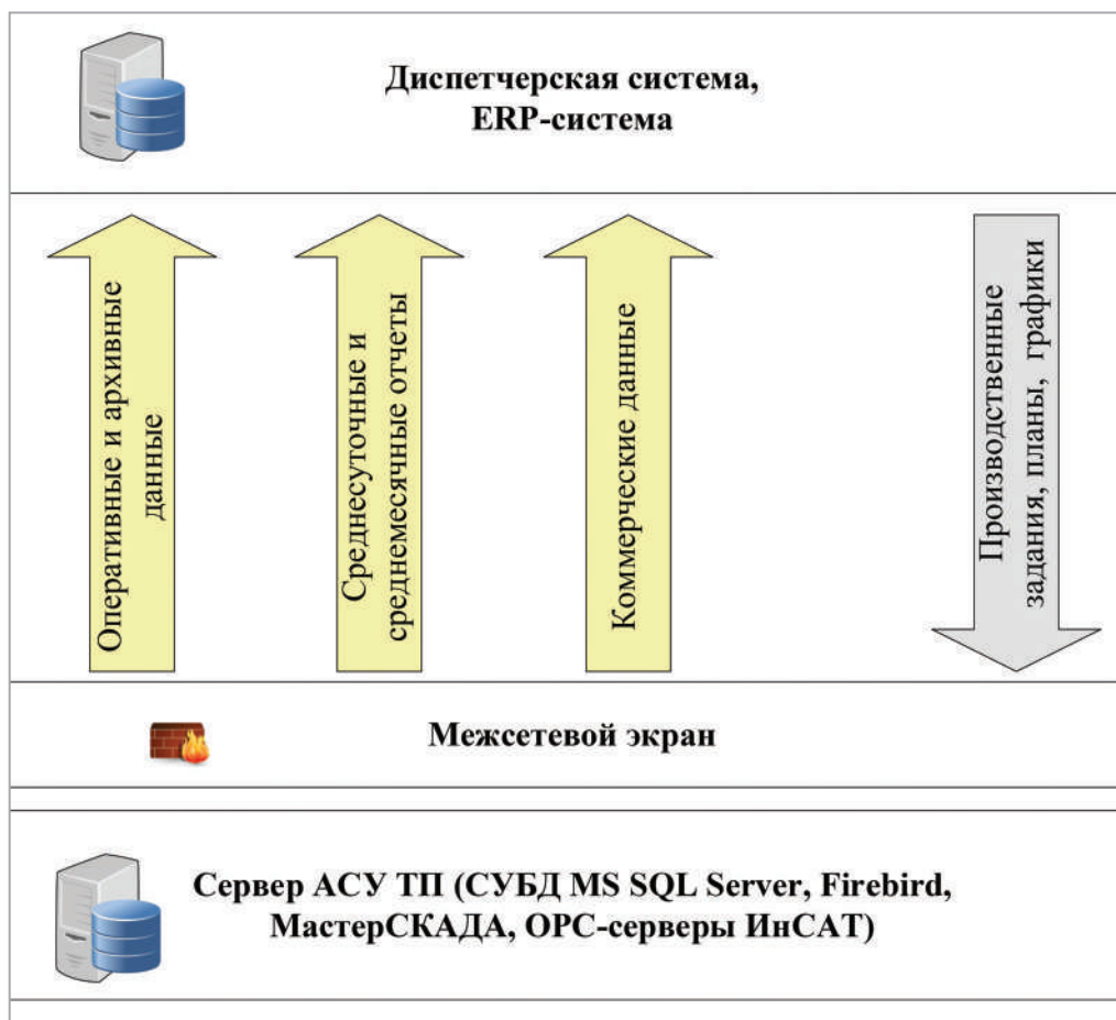
Рис. 5. Интеграция АСУ ТП в систему верхнего уровня
