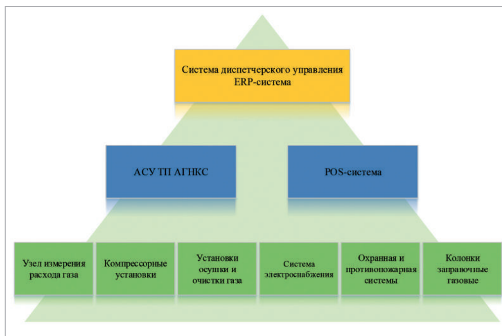
Рис. 1. Уровни автоматизации АГНКС
